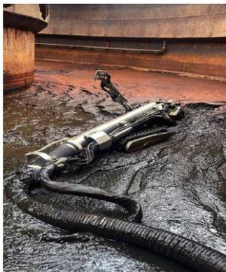
**Bonifica di terreni contaminati** da fuoriuscite di olio o liquidi, rimozione di polveri e ceneri.
